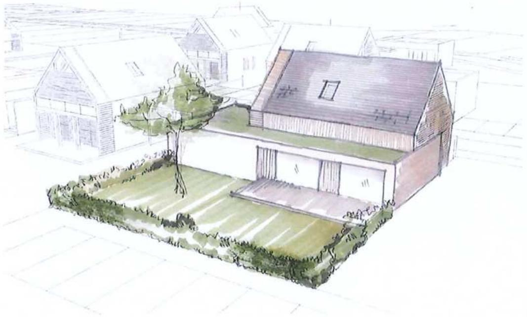
Implantation possible avec construction principale en toiture à deux pans et extension en toit terrasse pour le garage et le séjour.
